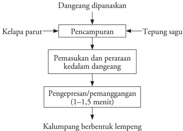
Gambar 1 Diagram alir proses pembuatan kalumpang
